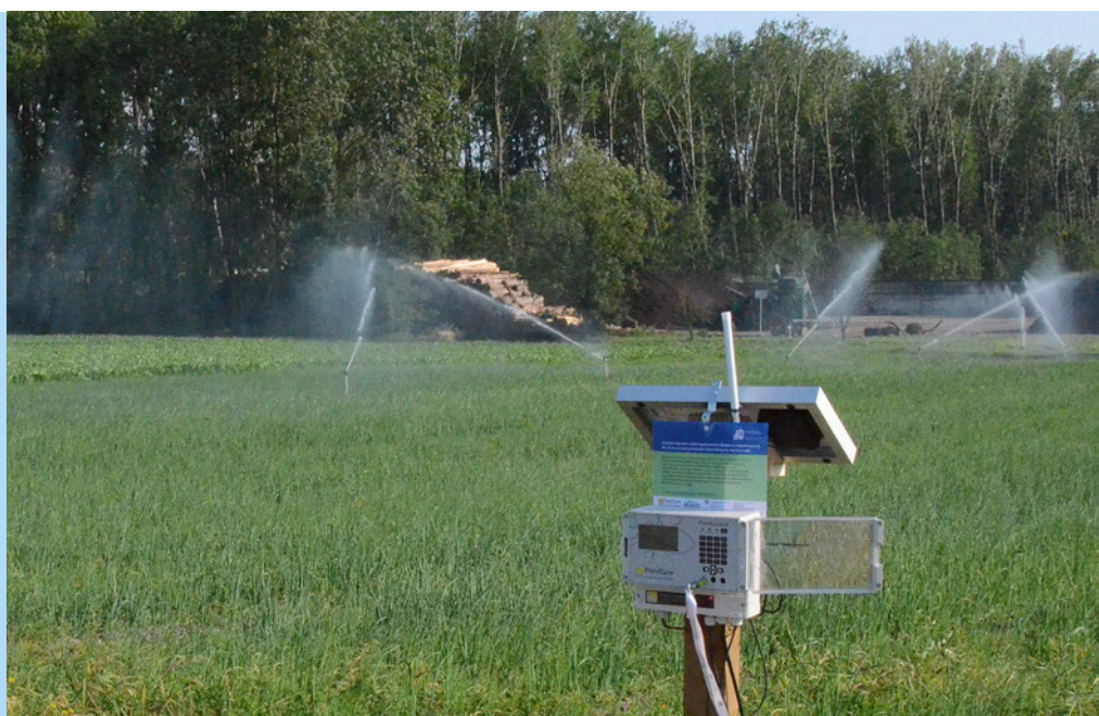
Der Bewässerungscomputer PlantControl CX steuert vollautomatisch die Sprinkleranlage auf einem Zwiebfeld.
