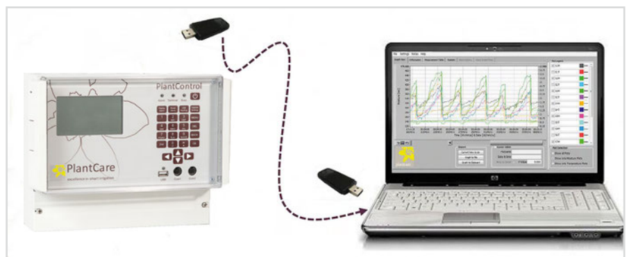
Bei Versuchsanstellern besonders willkommen ist das einfache Auslesen der Bewässerungsdaten via USB-Stick und die rasche Analyse der Daten mit der PlantCare-DataViewer-Software.
