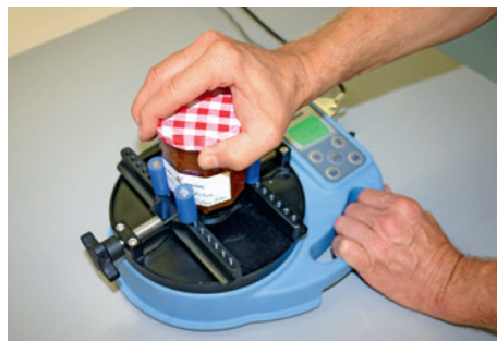
Abb. 2: Öffnungskraftmessung von Verpackungen mit Drehverschluss
