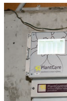
Oben: Die Pflanzenschau in Hombrechtikon ist seit letztem Sommer mit einer selbstregulierenden Bewässerung ausgestattet. Rechts: Der Bewässerungscomputer ist in einer platzsparenden Box untergebracht. Ganz rechts: Ein Sensor misst die Bodenfeuchte und sendet ein Signal an die Steuerung, sobald eine bestimmte Trockenheitsschwelle erreicht ist.
