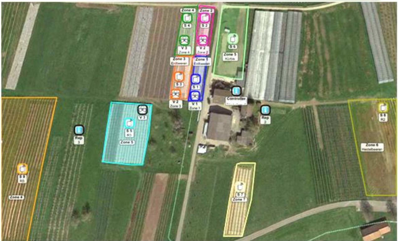
Abb.2: Anordnung der bewässerten Zonen, der Sensoren, Ventile und Funkrepeater
