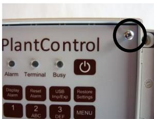
Die 4 Schrauben am Panel der Zentraleinheit lösen.
