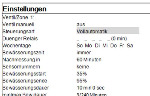
Bewässert wird nur dann, wenn der Sensor, welche diesem Ventil zugeordnet ist, die eingegebene Trockenschwelle erreicht hat. Sind mehrere Sensoren diesem Ventil zugeordnet, dann errechnet das System den Mittelwert. Zusätzlich wird die Bewässerungsdauer vollautomatisch und dynamisch angepasst (Dynamic Run Time Adjustment), sodass eine Über- oder Unterbewässerung verhindert werden kann.
