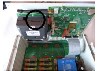
SIM-Karten Schublade öffnen und SIM Karte einsetzen (Details unten).
